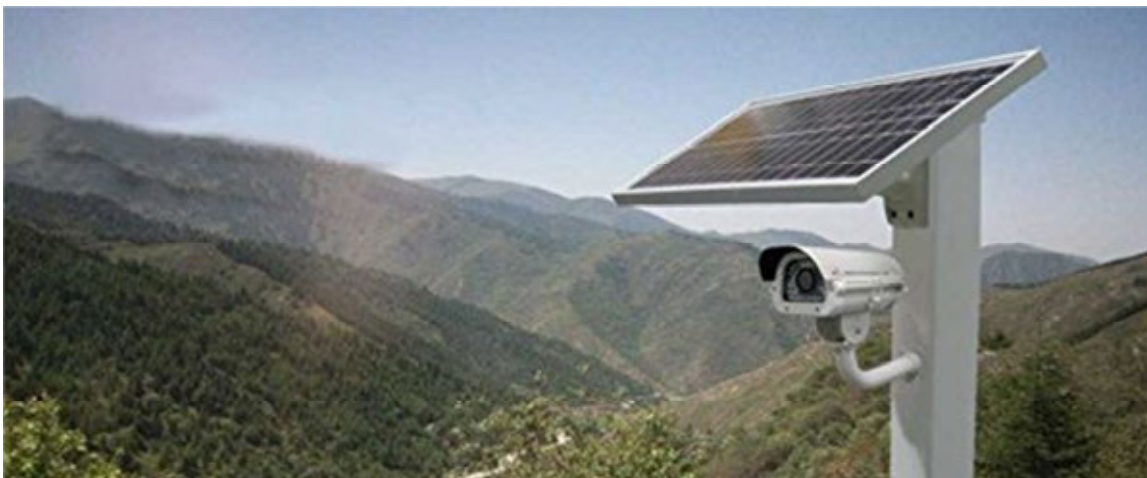
Fig. 42 – Cameră de monitorizare dotată cu celule fotovoltaice
